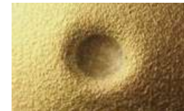
先端径 5/8in.(15.875mm) 錘 4lb(1.81kg) 高さ 4ft(1.22m)
