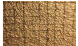
100°C水道水×48時間浸漬 テープテスト結果 剥離無し
